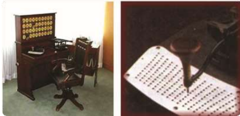
Máquina tabuladora de Hollerith
