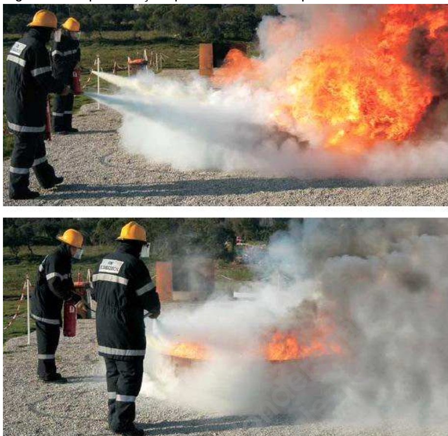
Figura: Exemplo extinção química. Extintor de pó.
