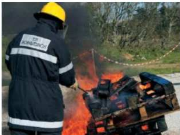
Figura: Exemplo de extinção por resfriamento. Extintor de água.
