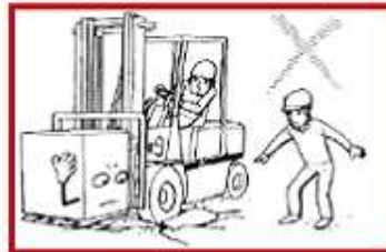
Certifique-se que o piso suporta o peso da empilhadeira com a carga.
