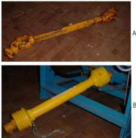
Eixo cardã da TDP (A) e sua proteção externa (B).
