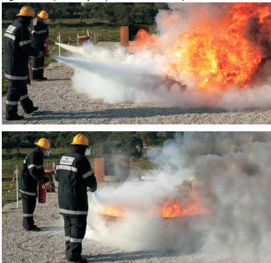
Figura: Exemplo extinção química. Extintor de pó.
